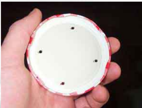
Prawidłowe rozmieszczenie otworów w metalowej pokrywce.
